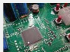
Блок серии H70 разработан для управления асинхронным однофазным двигателем переменного тока 230В с энкодерной системой контроля.
