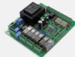
Блок серии H70 разработан для управления одним или двумя асинхронными однофазными двигателями переменного тока 230В.
